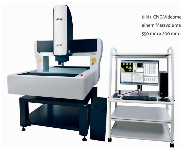
Bild 1. CNC-Videomesssysteme mit einem Messvolumen von 650 mm x 550 mm x 200 mm © Nikon
